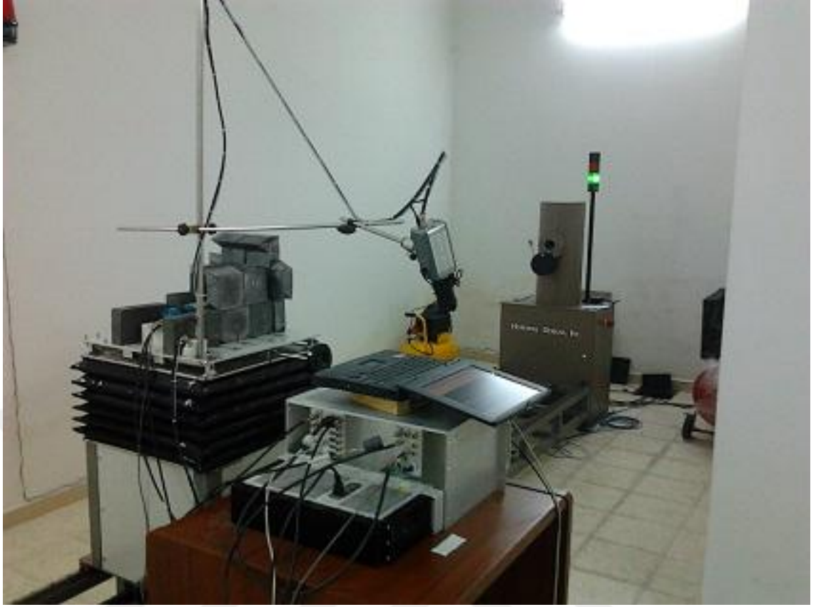
Şekil 3.2 Düşük ve yüksek aktiviteli ^{137}\text{Cs} ışınlama sistemi ve bu sistemle alınan ölçümler için kullanılan mobil 3D- radyometrik benç sistemi
