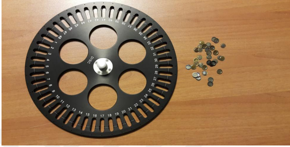
Şekil 3.3 Deneylerde kullanılan 48 örnek haznesine sahip döner tabla ile örneklerin yerleştirildiği kenarlıklı diskler
