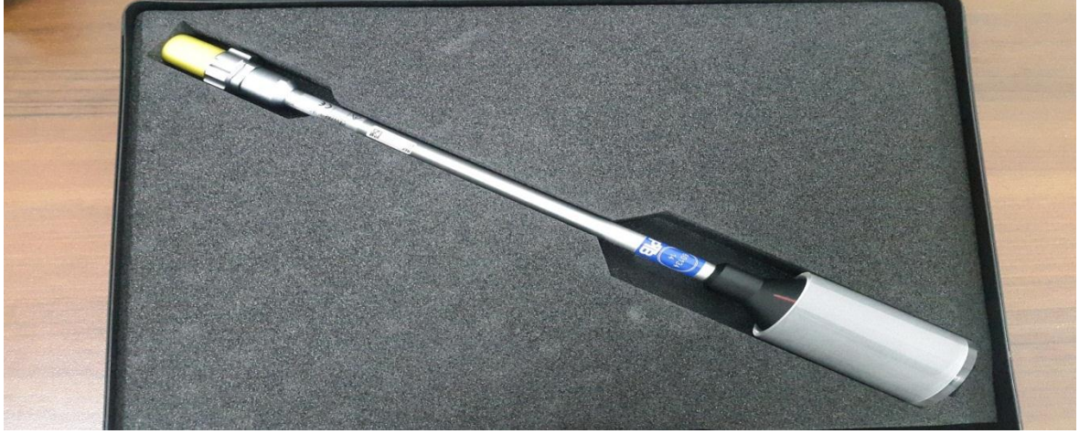
Şekil 3.1 PTW marka, 30 cm 3 hassas hacimli silindirik iyon odası(TM 23361)
