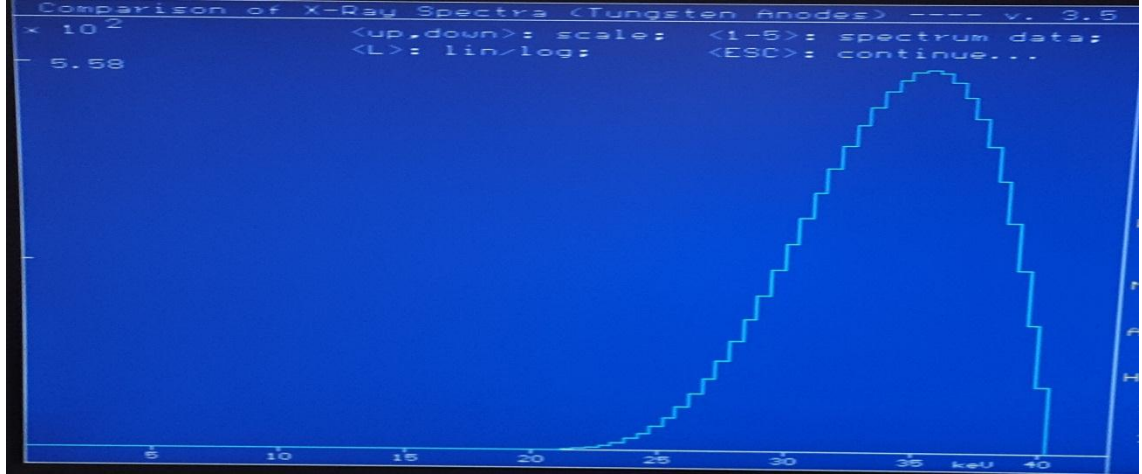
Şekil 4.8 H40, 40 kV p demet kalitesi için Xcomp5r programından elde edilen spektrum
