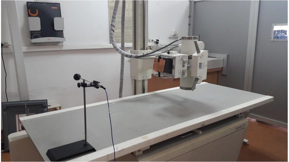
Şekil 4.2 NIST X-ışın demet kalitelerinin elde edildiği düzenek
