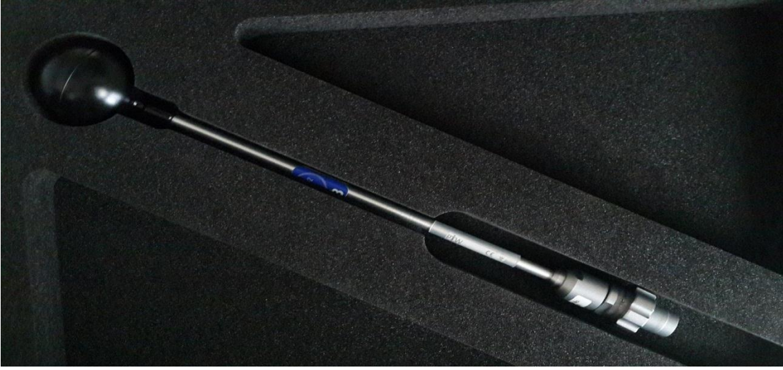
Şekil 3.2 PTW marka, 27,9 cm 3 hassas hacimli küresel iyon odası(TM 32005)
