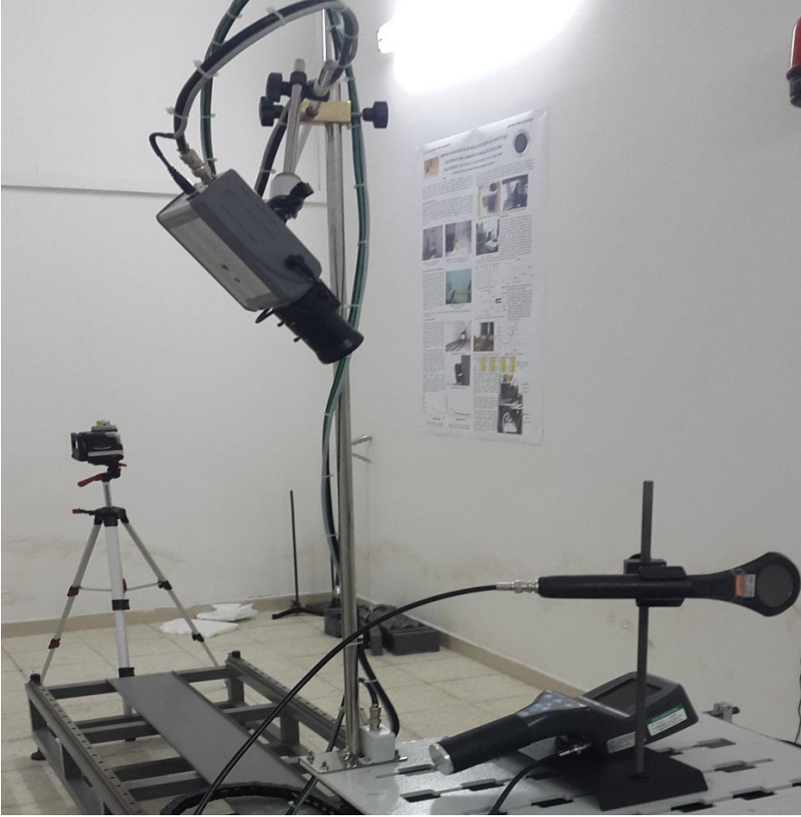
Şekil 3.4 Test objeleri örneği(dedektör tutucusu, kamera, lazer)
