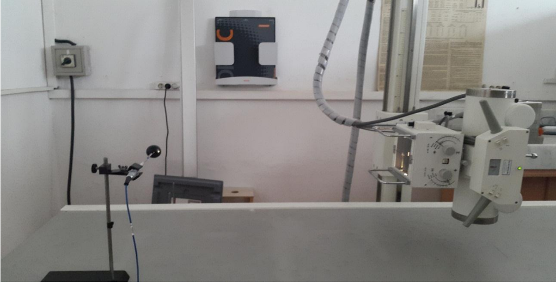
Şekil 4.15 ISO demet kalitelerinin elde edildiği düzenek
