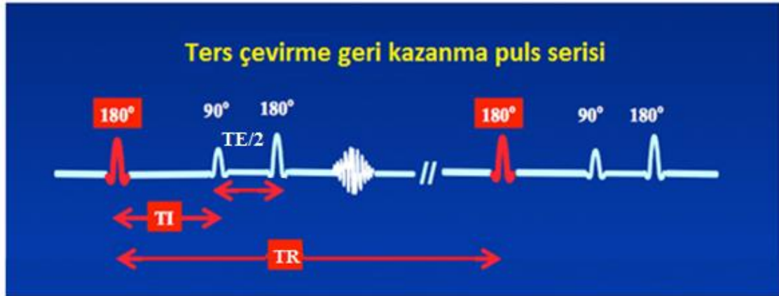
Şekil 2.89 Ters çevirme geri kazanma puls serisinde kullanılan TI, TE ve TR zamanları
