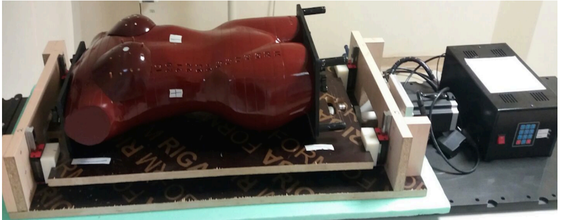
Şekil 3.15 Solunum hareketini simüle eden düzenek ve üzerinde RANDO fantomun set up'ı
