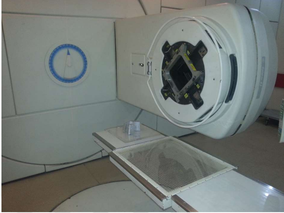
Şekil 3.6 Gazi Üniversitesi Tıp Fakültesi Radyasyon Onkolojisi Anabilim Dalı bünyesinde bulunan GE Saturn 43 lineer hızlandırıcı
