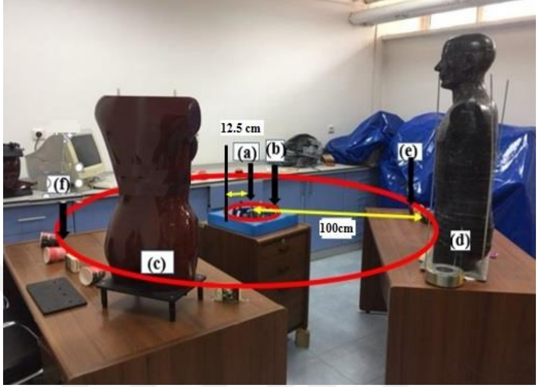
Şekil 3.12 Kaza senaryosunun görüntüsü : (a): kaynağın konumu, (b): malzemelerden elde edilmiş parçalar kaynaktan 12.5 cm mesafede sabitlenmiştir. (c): bayan Rando fantom, (d): erkek Rando fantom. (e) ve (f): konumları kaynaktan 100cm mesafede numune parçaların sabitlenmiş noktaları göstermektedir.
