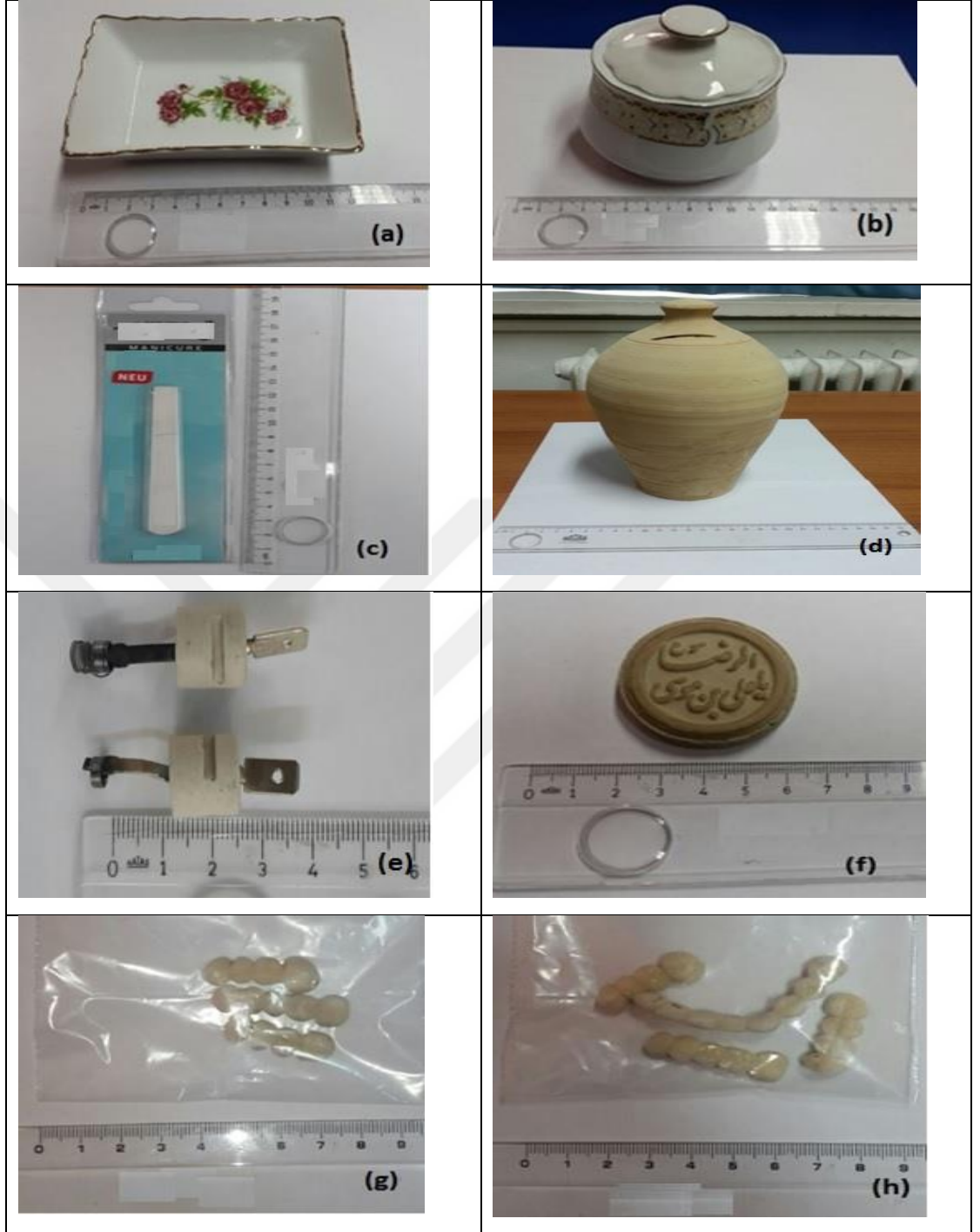
Şekil 3.8 Tez boyunca retrospektif dozimetri amaçlı incelenmiş malzemeler. a) porselen kül tablası; b) porselen şekerlik; c) seramik tırnak törpüsü; d) kumbara; e) sigorta porseleni; f) namaz mühürü; g) cila maddesi içerikli yapay diş porseleni ; h) cila maddesi içeriksiz yapay diş porseleni.
