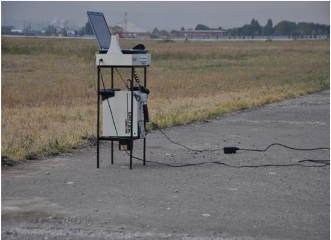
Şekil 4.6 Kalibrasyon bloku üzerinde in-situ HPGe dedektör ile ölçüm sistemi.
