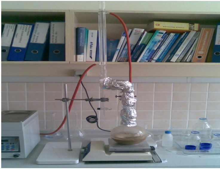
Resim 11: Buhar Distilasyon Sistemi (©)
