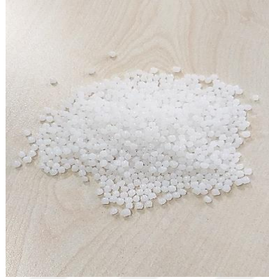
Şekil 3.14 Petkim Petrokimya Holding A.Ş’den temin edilen YYPE granül malzeme
