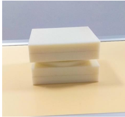
Şekil 3.28 Diğer görüntü kalitesi metriklerinin ölçümü için hazırlanan YYPE fantomun üçüncü modülünün homojen saçıcı plaka modülleri ile kullanımı
