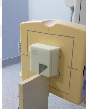
Şekil 3.27 Hazırlanan YYPE fantomun ilgili modüllerinin eDQE hesaplamalarında kullanılacak eMTF, eNNPS ve SF ölçümü için kullanımı
