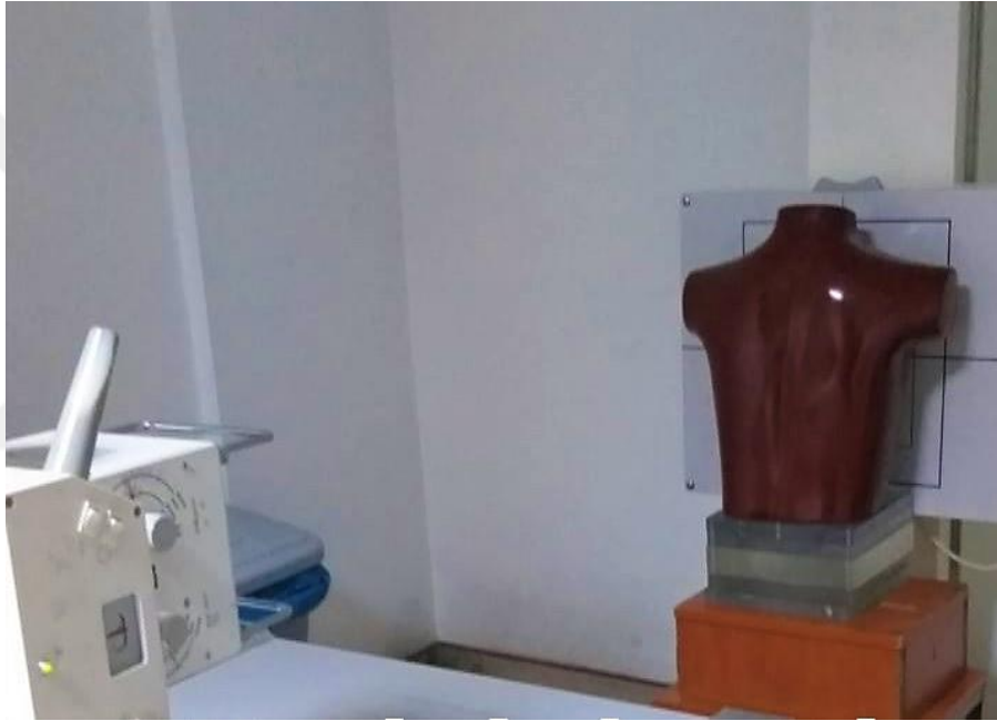
Şekil 4.32 Akciğer fantomunun rutin akciğer protokolüne uygun olarak PA (posteroanterior) pozisyonda görüntülenmesi
