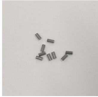
Şekil 3.20 Fantoma monte edilmek üzere hazırlanan kurşun çubuklar
