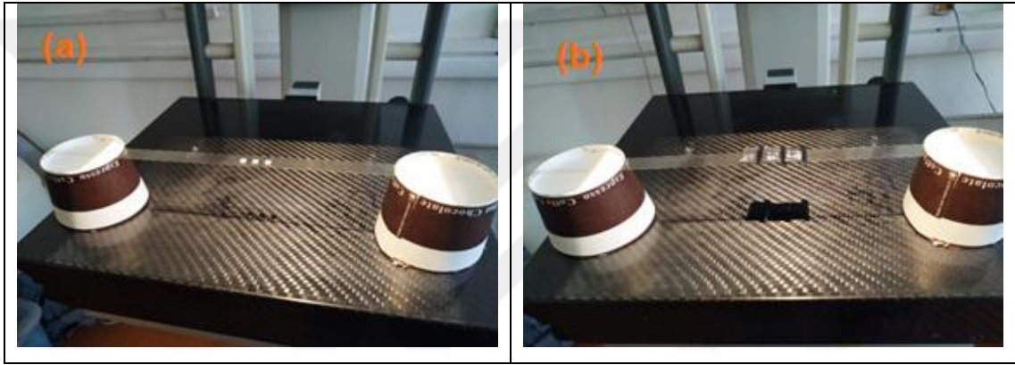
Şekil 4.50 Geri saçılım faktörünün (BSF) belirlenmesi için dozimetrelerin havadaki ışınlama düzeneęi; a) TLD-100, b) BeO dozimetreler
