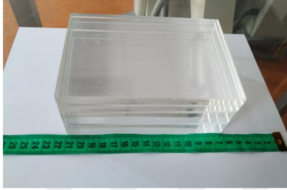
Şekil 3.11 Meme eşdeğeri PMMA (polimetilakrilat) fantomlar
