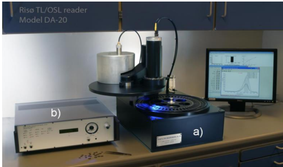
Şekil 3.1 Risø TL/OSL Sistemi a) örneklerin yerleştirildiği, uyarımın ve ışınlamanın yapıldığı kısım, b) sinyal işleme, kaydedilme ve aktarılmanın yapıldığı kısım.
