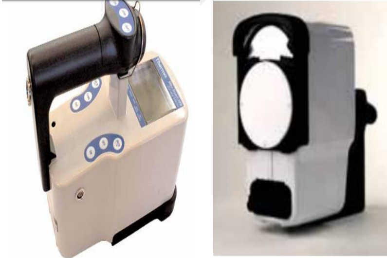
Şekil 3.3 MiniSmartIon 450 cm 3 ion kontaminasyon dedektörü (Thermo Electron Corp.,2019)
