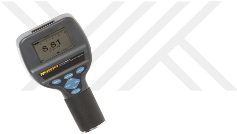
Şekil 2.6 Tava tipi Geiger - Müller dedektörü ( https://www.flukebiomedical.com )
