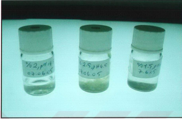
Şekil 2.4.: Değişik konsantrasyonlarda hazırlanmış jel formda kitosan
