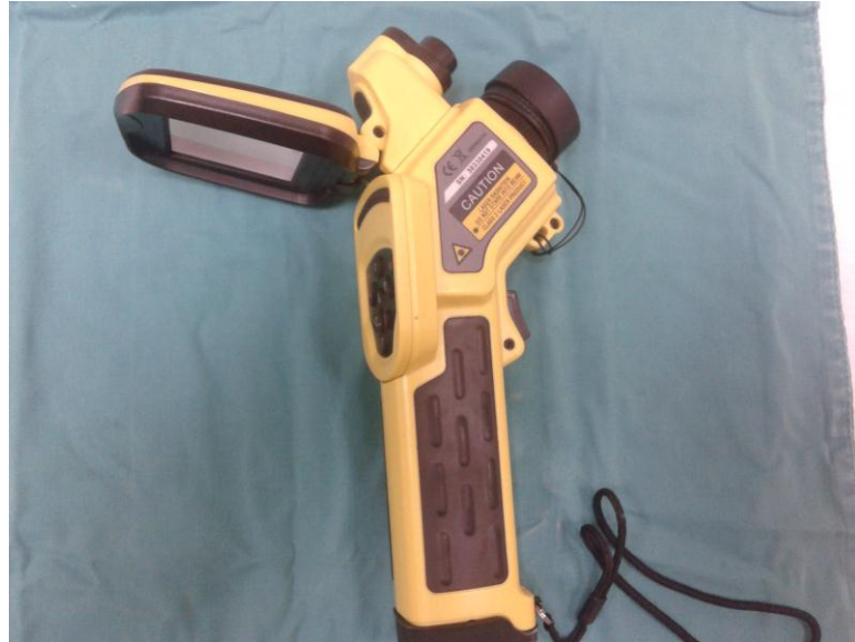
Resim 9: Çekim esnasında kullanılan Trotec IC-080LV termografik kamera
