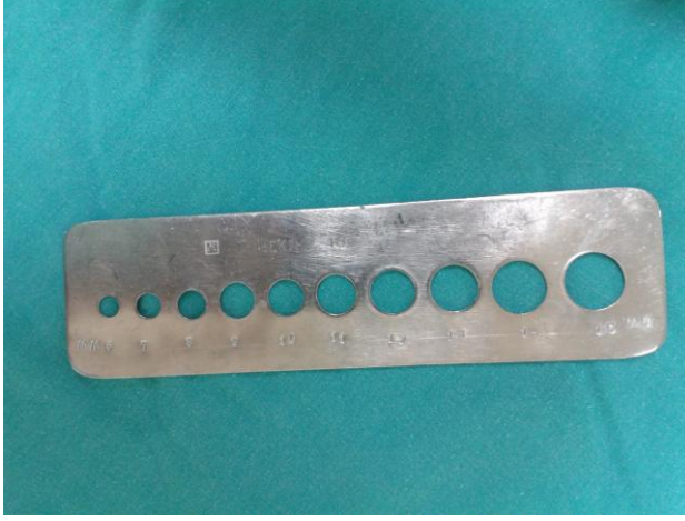
Resim -16 Greft çapını ölçmek için kullandığımız delikli çap ölçer
