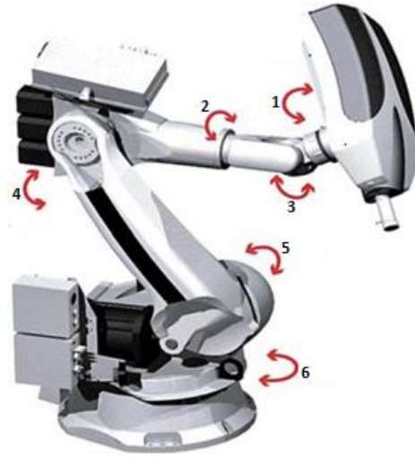
Şekil 2. 4. Altı eksenle hareket edebilen robotik kol
