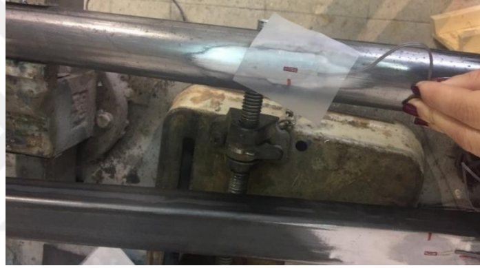
Şekil 3.20. Strain-gauge yapıştırılan numuneler
