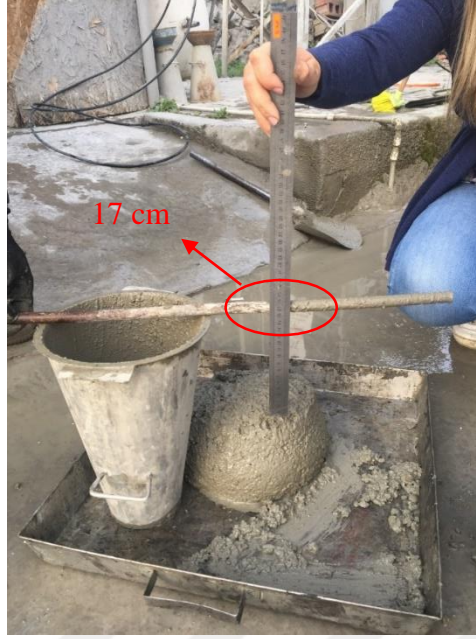
Şekil 3.10. OPC beton Slump Deneyi
