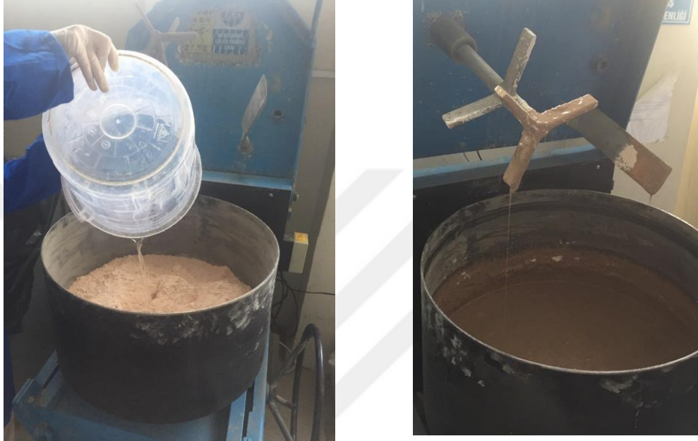
Şekil 3.5. Karışımı tamamlanmış geopolimer beton
