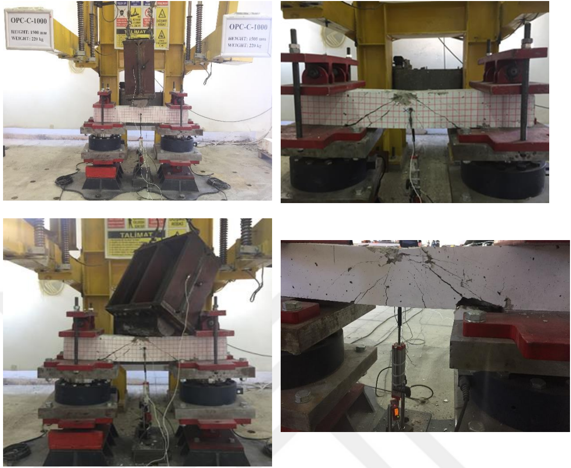
Şekil 4.6. OPC-C-1000 kompozit kiriş numunesine ait deney öncesi ve sonrası görüntüleri
