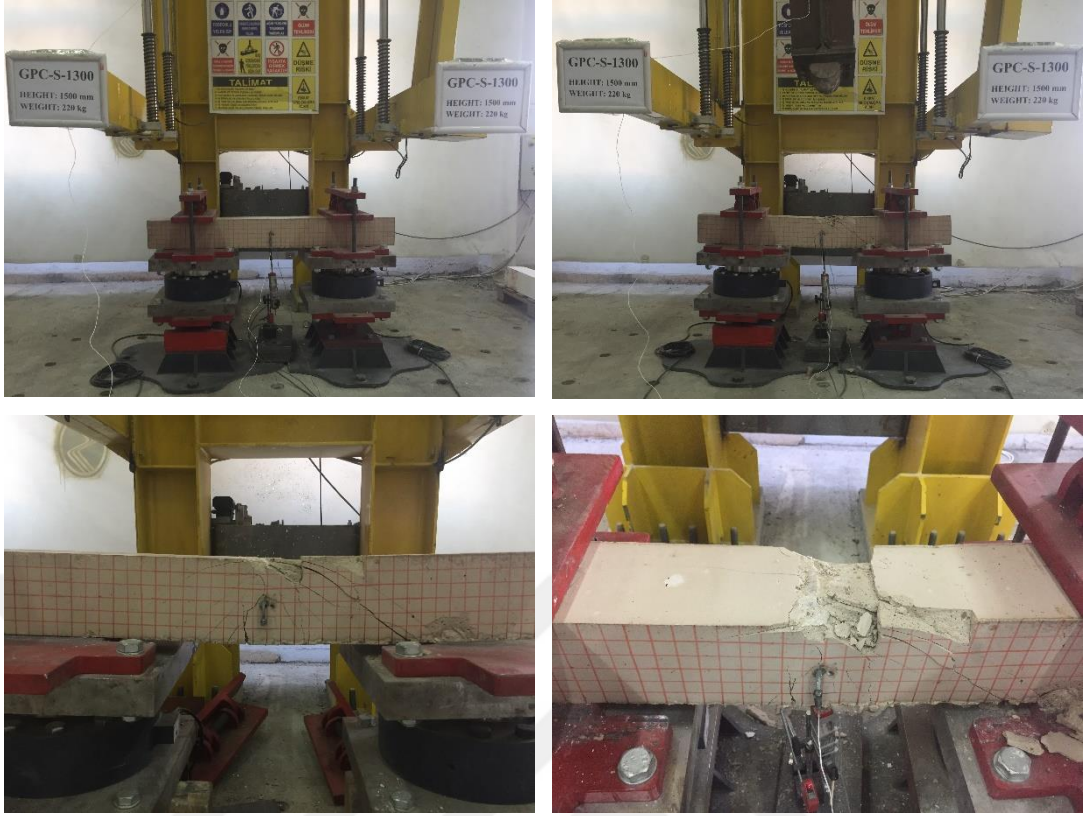
Şekil 4.21. GPC-S-1300 kompozit kiriş numunesine ait deney öncesi ve sonrası görüntüler
