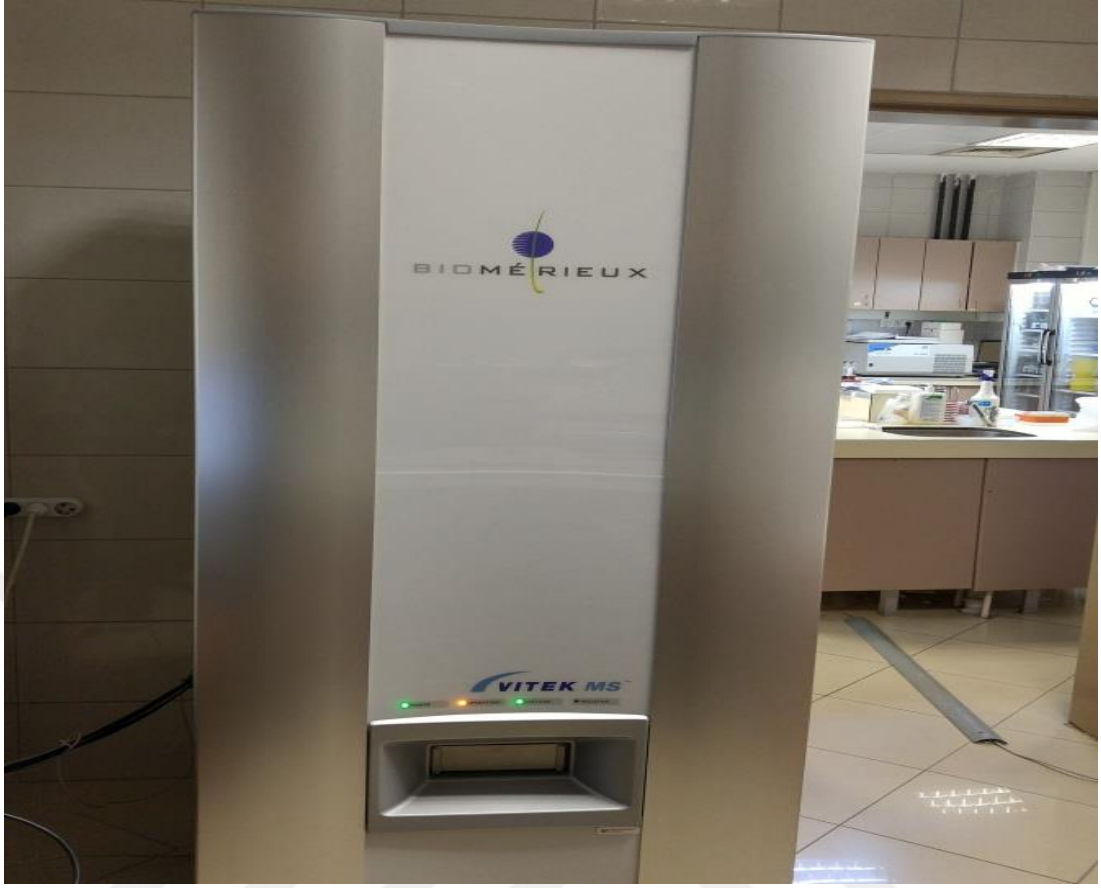
Resim 13. MALDI-TOF MS cihazında özel okuma laminin verildiği bölüm
