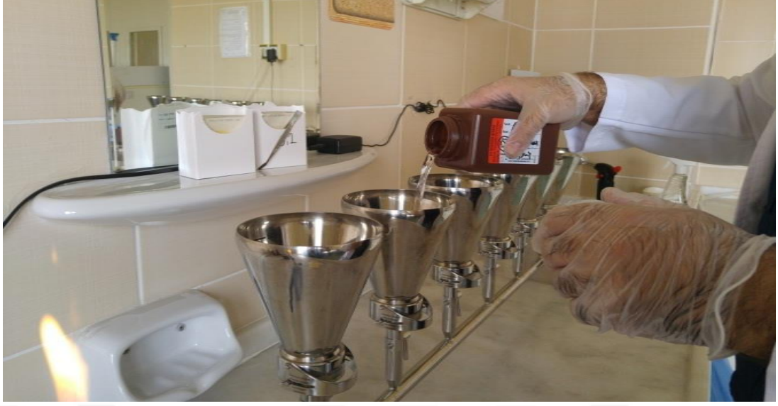
Resim 3. Membran filtrasyon sisteminden su örneğinin süzülmesi
