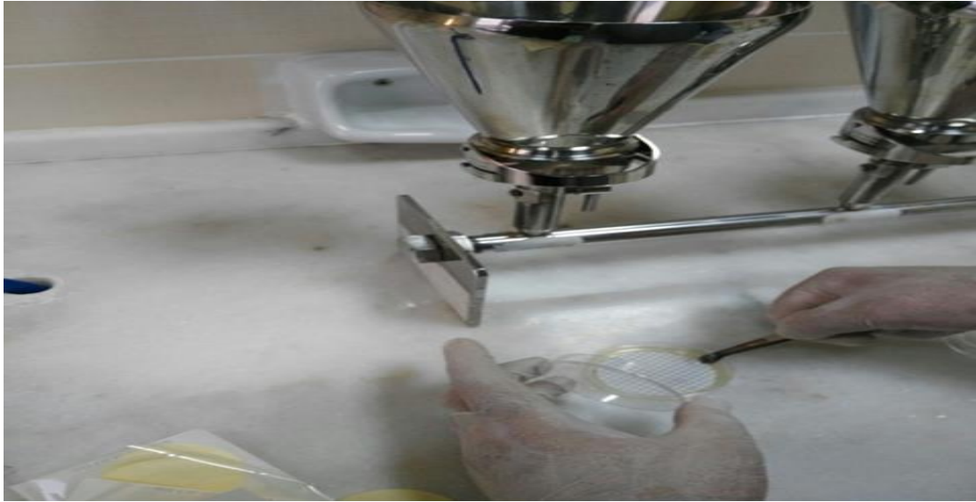
Resim 4. CCA besiyeri üzerine yerleştirilen membran filtre
