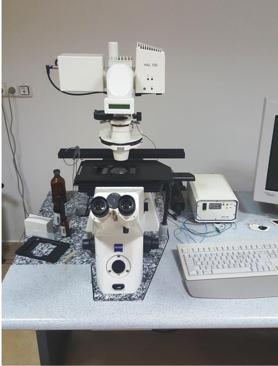
Şekil 3.11. Kesitlerin incelendiği Confocal laser taramalı mikroskop
