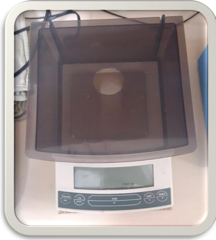
Şekil 3.2. Kullanılan pata %0.1 oranında Rodamin-B ilave edilirken kullanılan hassas tartı
