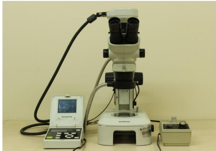
Şekil 3.3: Örneklerde boya penetrasyonunu ölçmek ve dijital fotoğrafını çekmede kullanılan ışık mikroskobu (Olympus SZ61, Tokyo, Japonya)
