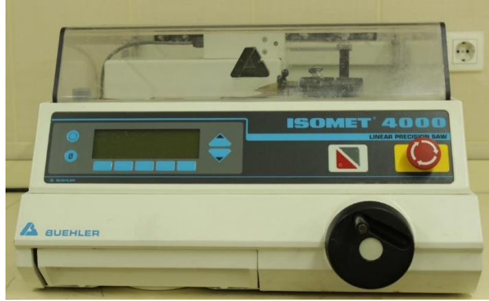
Şekil 3.2: Örneklerden kesit almada kullanılan düşük hızlı, su soğutmalı elmas separeli kesim cihazı (Isomet 4000, Buehler, Lake Bluff, IL, A.B.D.)
