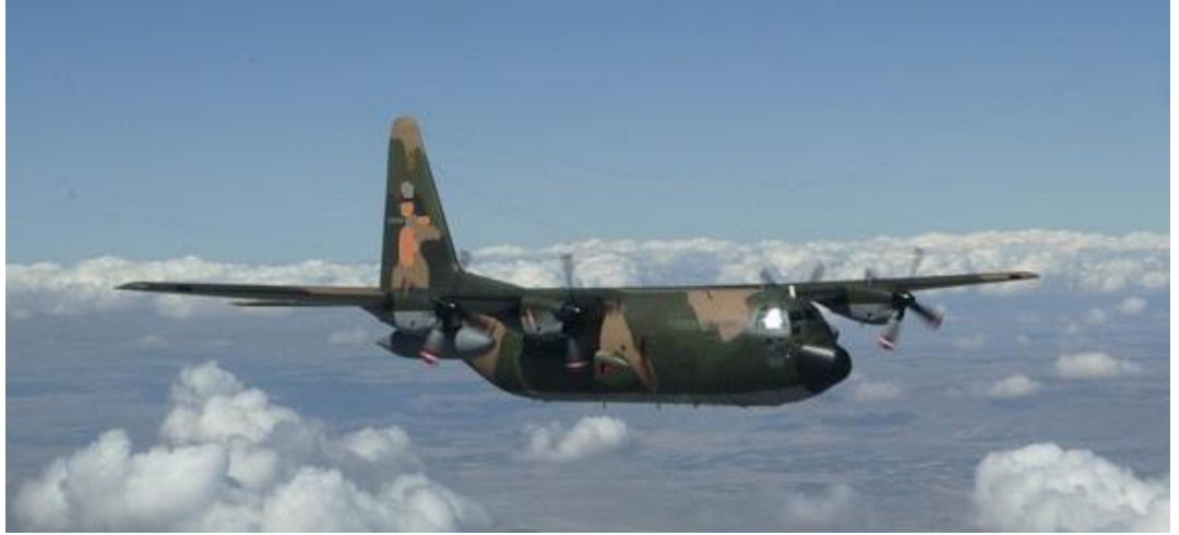
Resim 1. C-130 askeri nakliye uçağının 4 motoru bulunmakta olup her motor pervanesinin 6 kanadı mevcuttur (23).
