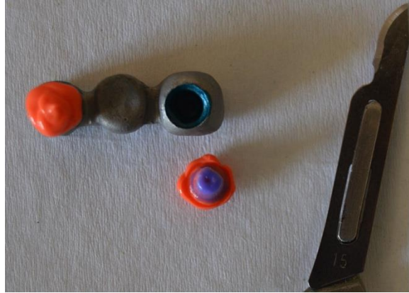
Şekil 3.22. Defromasyona uğramadan örneklerin içinden çıkarılan silikon replika örneği
