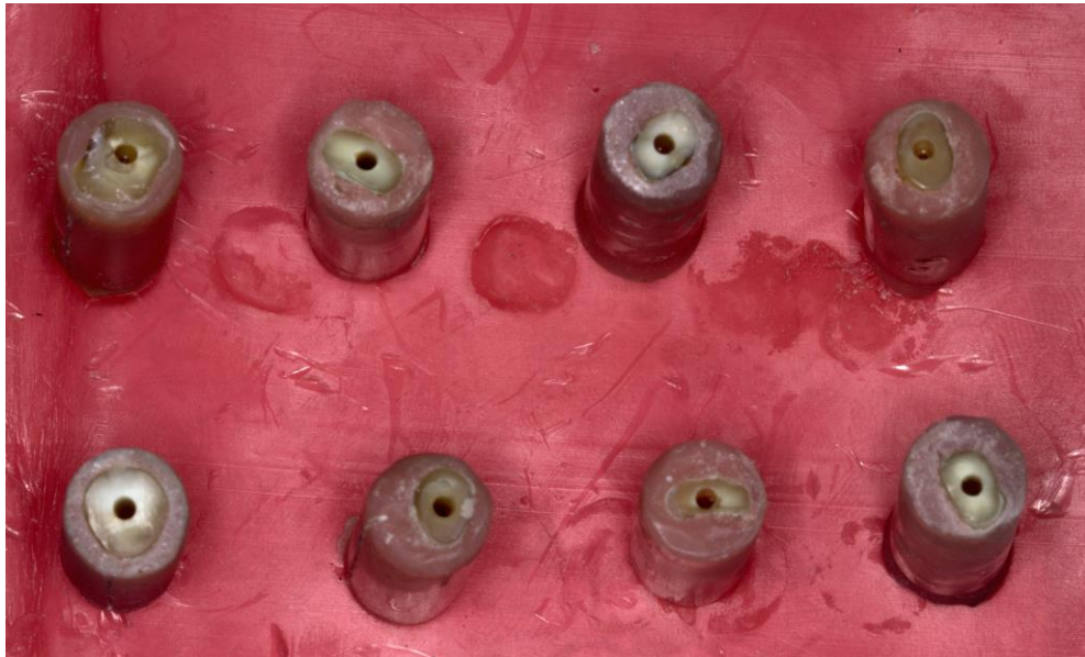
Şekil 3.2. Soğuk akril içerisine gömülerek hazırlanan örnekler.
