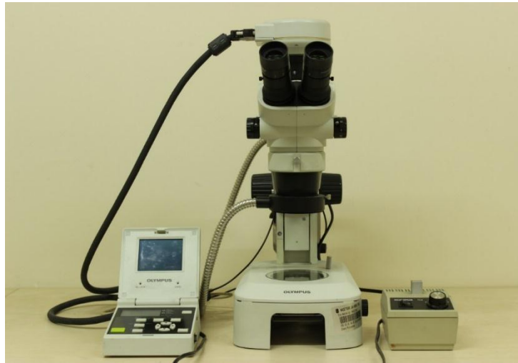
Şekil 3.3. Örneklerde boya penetrasyonunu ölçmek ve dijital fotoğrafını çekmede kullanılan ışık mikroskopu (Olympus SZ61, Tokyo, Japonya)
