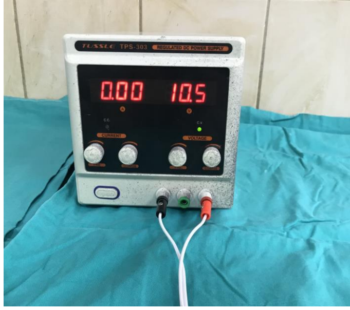
Şekil 9: 1mA şiddetinde elektrik akımı sağlayacak olan güç kaynağı (Tusle TPS-303 0-30V 3A Laboratuvar Tip Ayarlı Güç Kaynağı)
