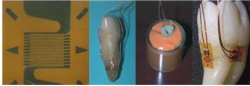
Şekil 2.23. Gerinim ölçer yönteminde diş yüzeyine yerleştirilen gauge 'lar
