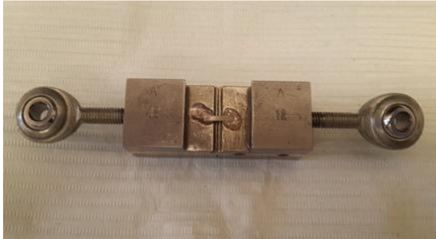
Şekil 3.9. Örneklerin test bloğuna yapıştırılması
