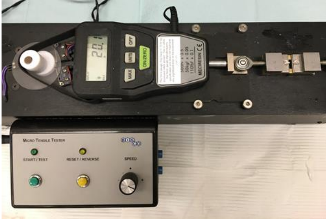
Şekil 3.10. Bağlanma dayanımı testlerinin uygulanması
