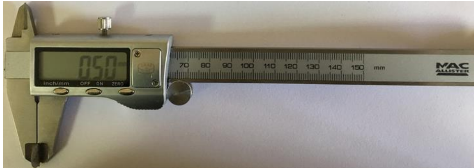
Şekil 3.5. Hazırlanan metal altyapıların kalınlığının dijital kumpasla ölçülmesi.
