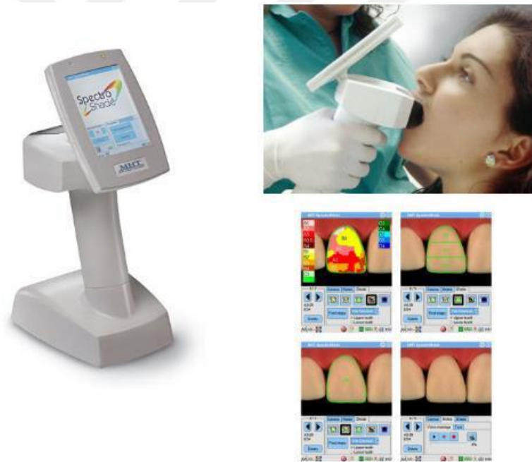
Şekil 2.11. SpectroShade Micro (MHT Optic Research, Niederhasli, İsviçre) (67).
