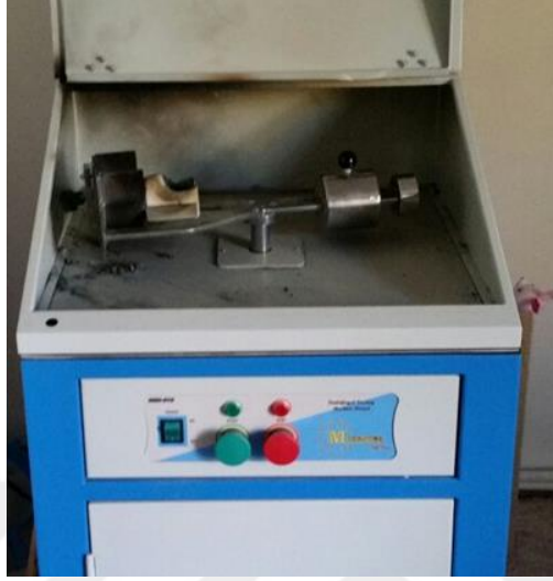
Şekil 3.3. Çalışmamızda kullanılan santrifüjlü döküm fırını.
