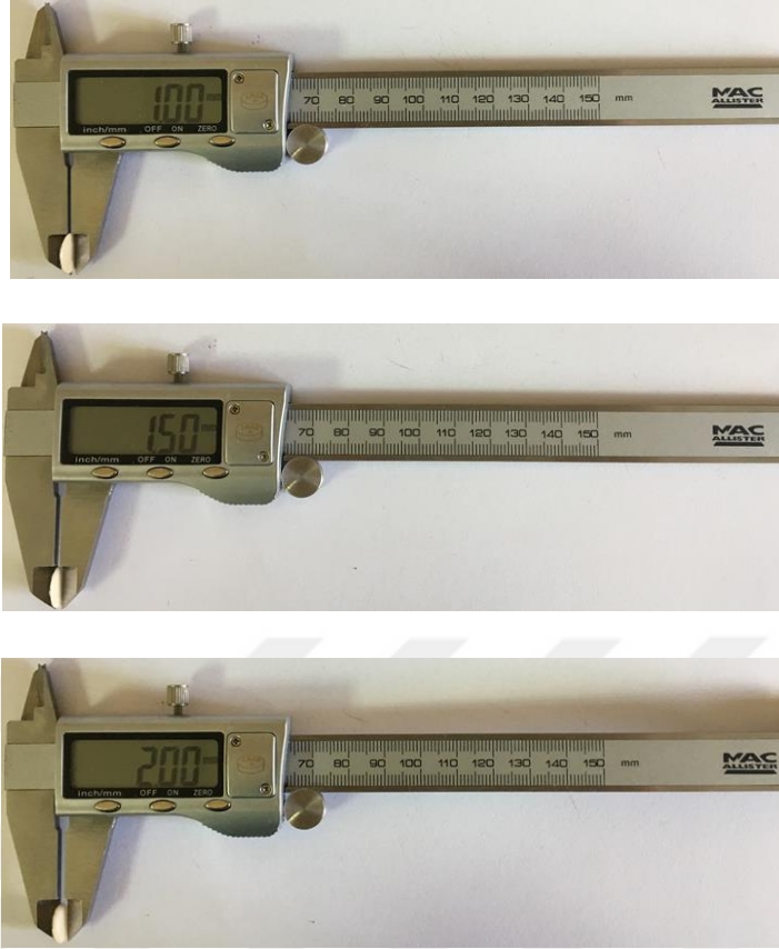
Şekil 3.9. Metal destekli porselen örneklerin kalınlıklarının ölçülmesi (0,5mm metal + 0,5;1;1,5 mm porselen kalınlığı: 1mm;1,5mm;2mm).
