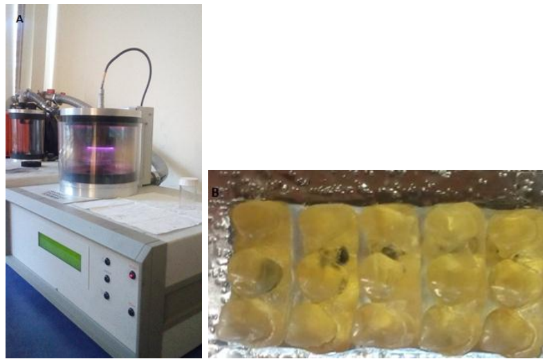
Şekil 3.8. A. Modellerin altınla kaplanması işlemi B. Altınla kaplanmış modeller
