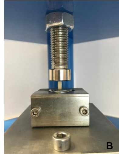
Şekil 3.6. A: Sıkışma dayanıklılık testinde kullanılan üniversal test cihazı (Mod Dental, Ankara, Türkiye); B: Üniversal test cihazına yerleştirilen örneğin görünümü.
