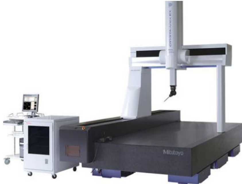
Şekil 2. 24. Bir ko-ordinat ölçüm cihazı görüntüsü ve kontrol ünitesi.
