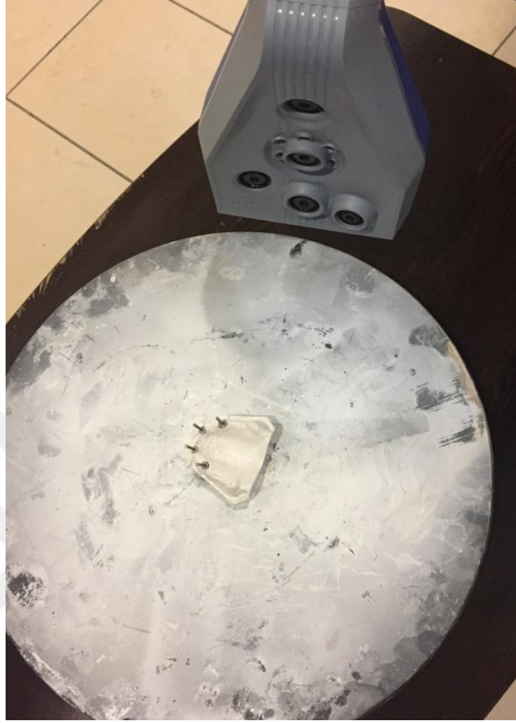
Şekil 3.18. Lazer tarama cihazı ve tarama tablası.
