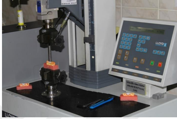
Şekil 3.3. Restorasyonlara kırılma testi uygulanması
