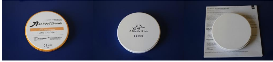
Şekil 2.4. Çalışmamızda kullanılan monolitik zirkon bloklar
