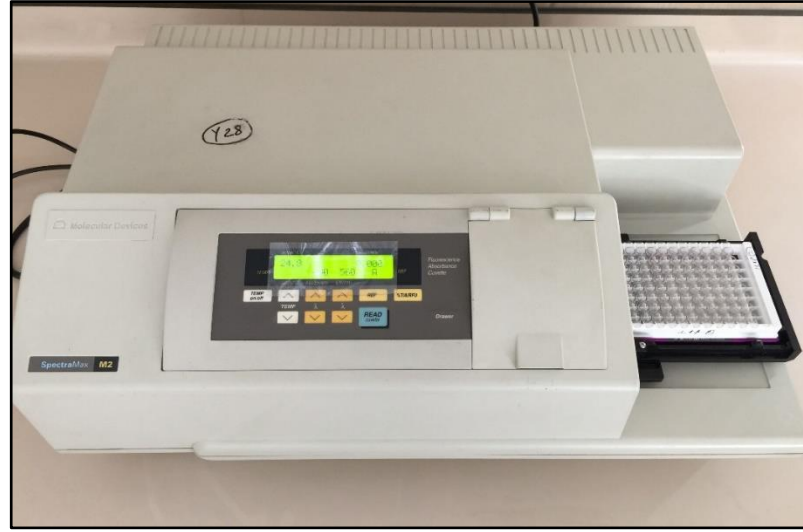
Şekil 3.7. Mikroplaka okuyucu (Molecular Devices, SpectraMax M2 Model)
