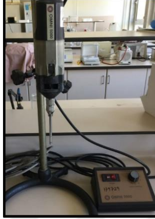
Şekil 3.6. PRF örneklerinin homojenizasyonunda kullanılan homojenizatör cihazı
