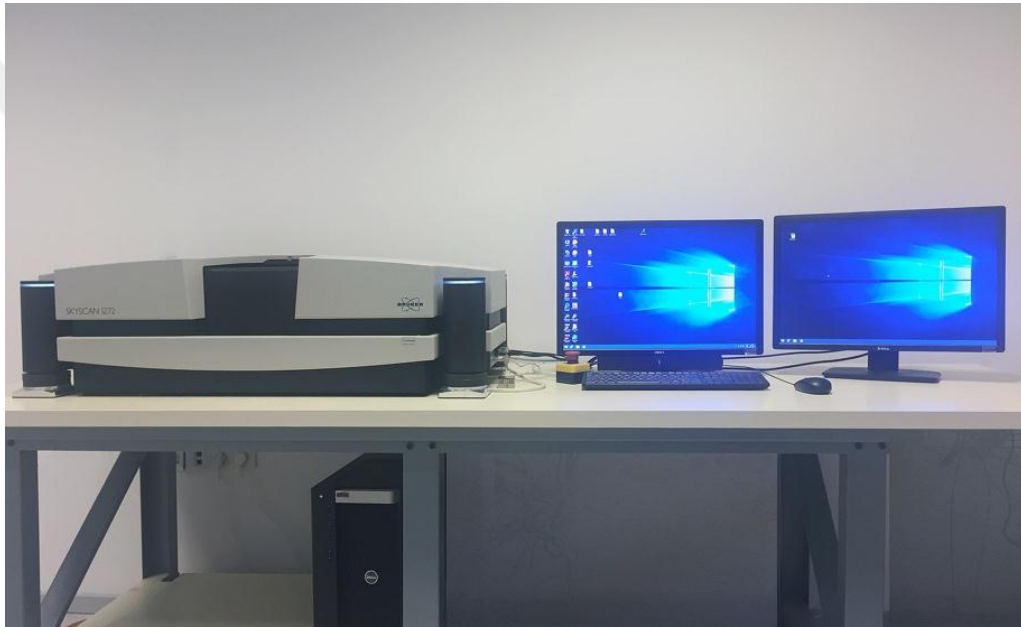
Şekil 3.3. Örneklerin taranmasında kullanılan mikro bilgisayarlı tomografi cihazı
