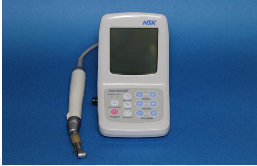
Şekil 3.4. Kök Kanal preparasyonunda kullanılan endomotor (NSK Endo-MateDT NE131, Tochigi, Japonya)
