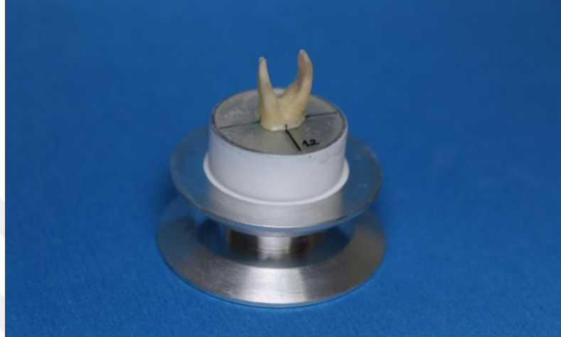
Şekil 3.1. Tarama sırasında kullanılan tutucu ve akrilik plak
