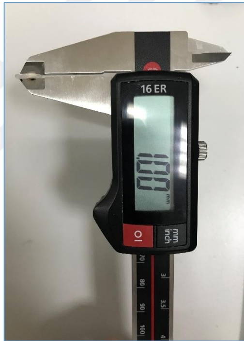
Şekil 3.11. Elde edilen kesitlerin kalınlıklarının dijital kumpas ile ölçülmesi.
