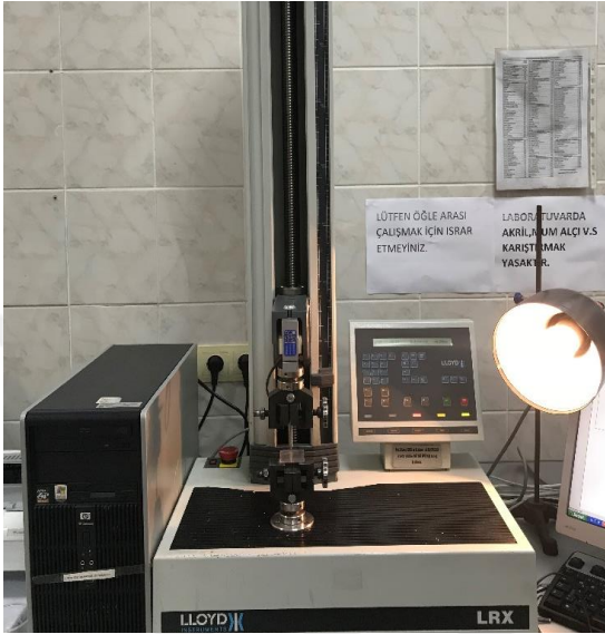
Şekil 3.12. Push-out testi için kullanılan universal test cihazı.
