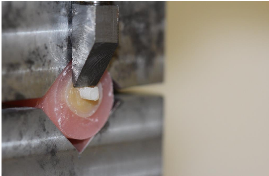
Şekil 3.12. Makaslama bağlanma dayanımı testi uygulaması
