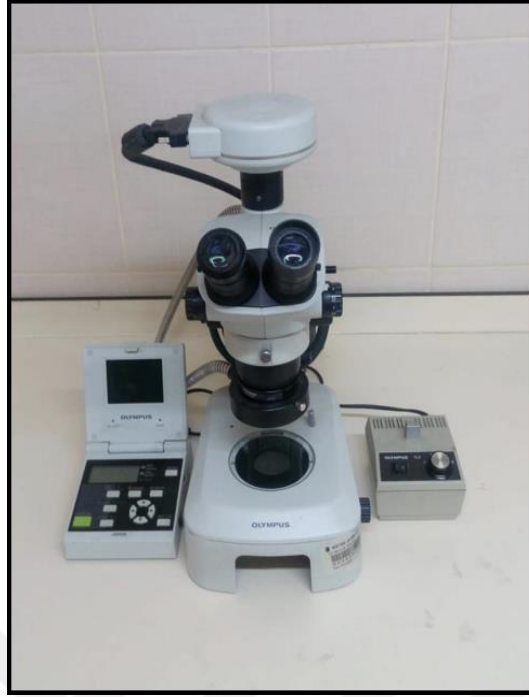
Şekil 3.5. Örneklerde boya penetrasyonunu ölçmek ve digital fotoğraflarını almada kullanılan ışık mikroskopu (Olympus Stereomikroskop, SZ-61, Tokyo, Japonya).
