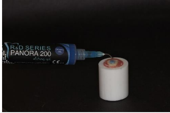
Şekil 3.10. Diş yüzeylerinin %37' lik fosforik asit ile pürüzlendirilmesi
