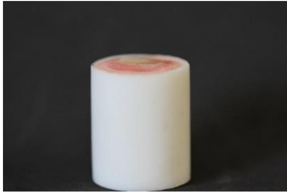
Şekil 3.3. Dişlerin yüzeyinin kalıbın üst seviyesiyle eşit hale getirilmesi
