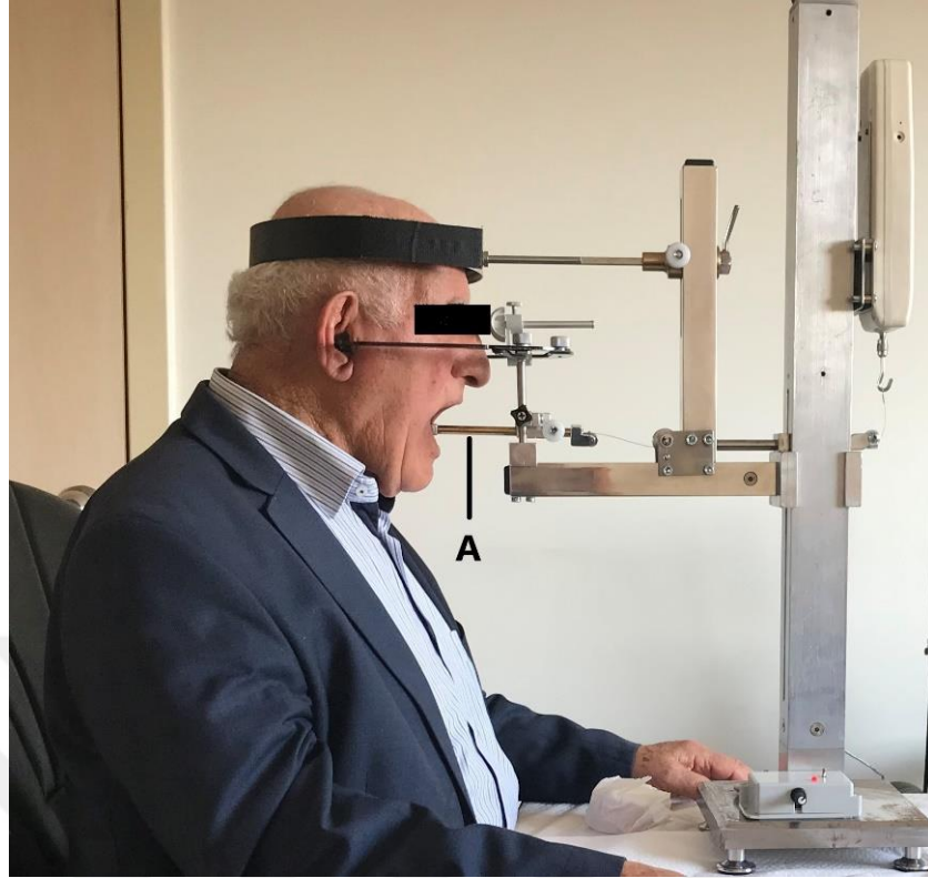
Şekil 3.12. Protez tutuculuğunun ölçülmesi; Kuvvet iletimi(A)
