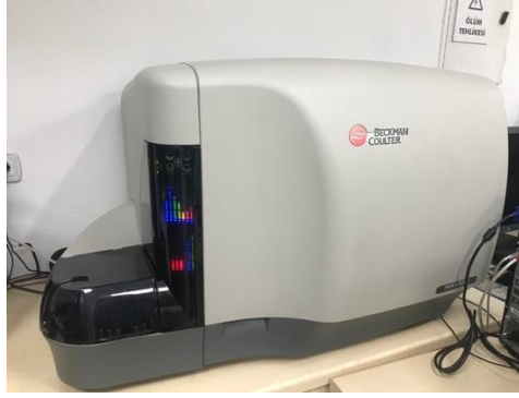
Şekil 3.17. Akış sitometri analizi yapılan akış sitometri cihazı (BECKMAN COULTER, NAVIOS FLOW CYTOMETER, Kaliforniya, Amerika Birleşik Devletleri)
