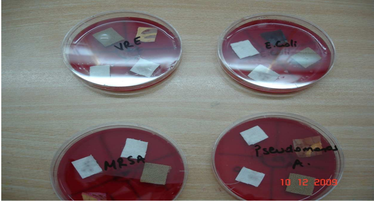
Resim-3 Kumaş kuponları üzerindeki bakterilerin canlı olup olmadıklarının kontrolü.
