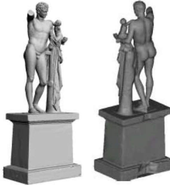
Resim 49. Heykele ait lazer tarama verilerinin birleştirilmiş modelinin üç boyutlu görüntüleri.
