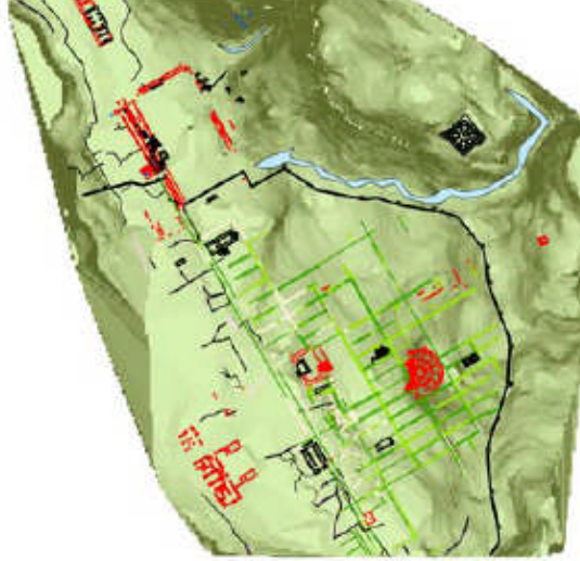
Resim 112. Eğim levhası bir raster verisidir. İleride yapılacak uzaysal veri analizi için gereklidir.
