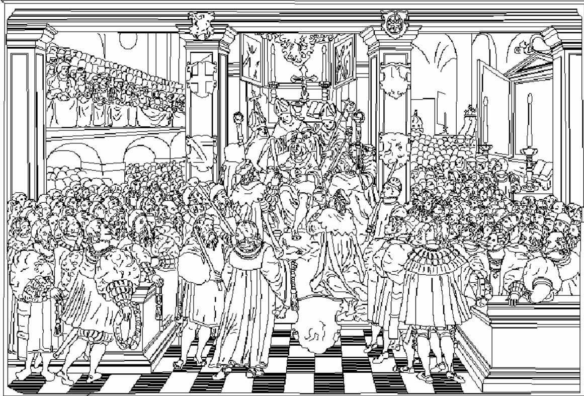
Resim 31. Stereofotogrametrik görüntülerden makine ile çizim. (Fotoğraf ve Makine Çizimi: Linsinger Vermessung). Ölçek 1:5.
