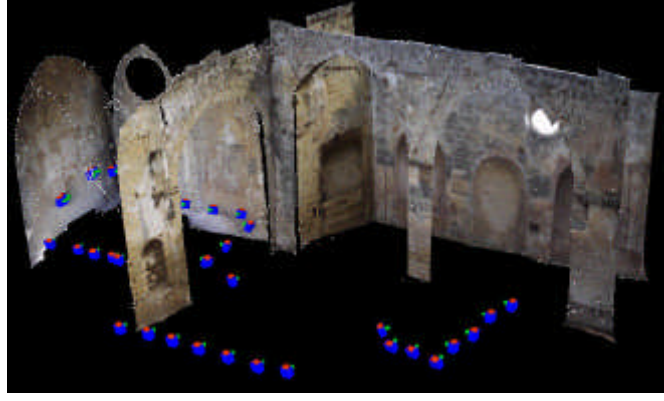
Resim 76. Kilise giriři, avlu ve kemerlerinin Photomodeler yazılımı kullanılarak yapılan üç boyutlu modeli. Sol kilise duvarı ve tonoz yapısı kilise içindeki kamera pozisyonlarını engellemiřtir.
