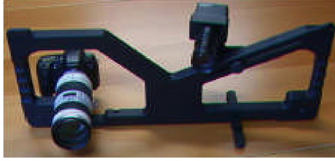
Resim 36. Sol tarafta bir CCD kamera ve sağ üst orta kısımda flaş ışığı monte edilmiş bir "Eyetric's ShapeCam"
