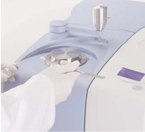
Şekil 2.14. ATR ye tutkal filmini yerleştirirken
