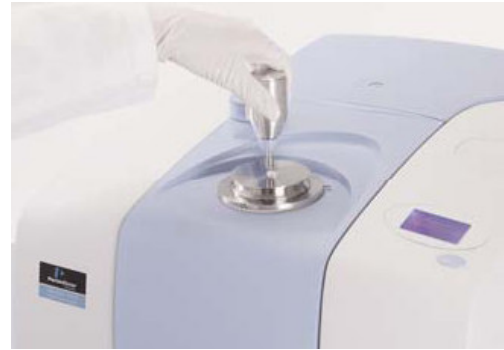
Şekil 2.15. ATR de tutkal filmini sıkıştırırken
