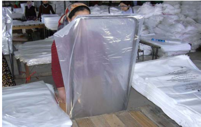
Figure 2.4. Pulling down the PE sack
