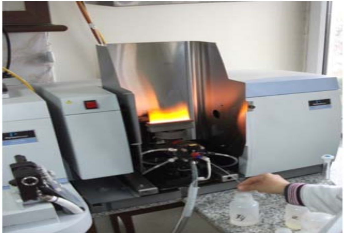
Şekil Ek2.6. AAS Cihazında toprak, makro ve mikro element analizi
