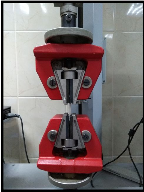
Şekil 3.4.2 : Klemplerin ucuna yerleştirilen tendon
