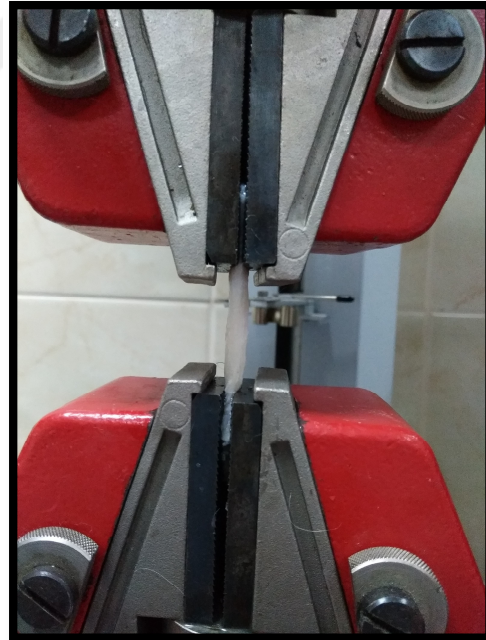
Şekil 3.4.2 : Klemplerin ucuna yerleştirilen tendon
