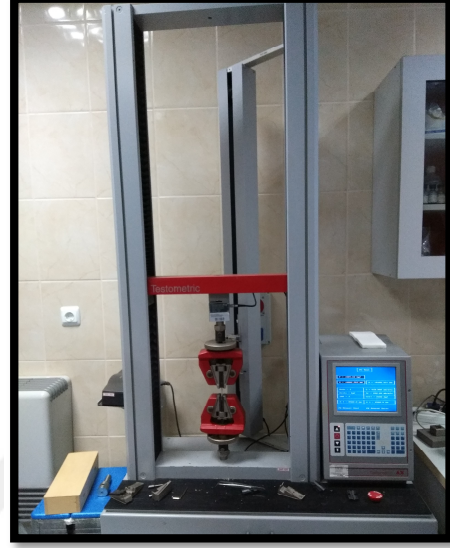
Şekil 3.4.1: Testometric marka çekme cihazı
