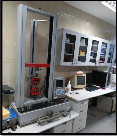
Şekil 3.4.1: Testometric marka çekme cihazı
