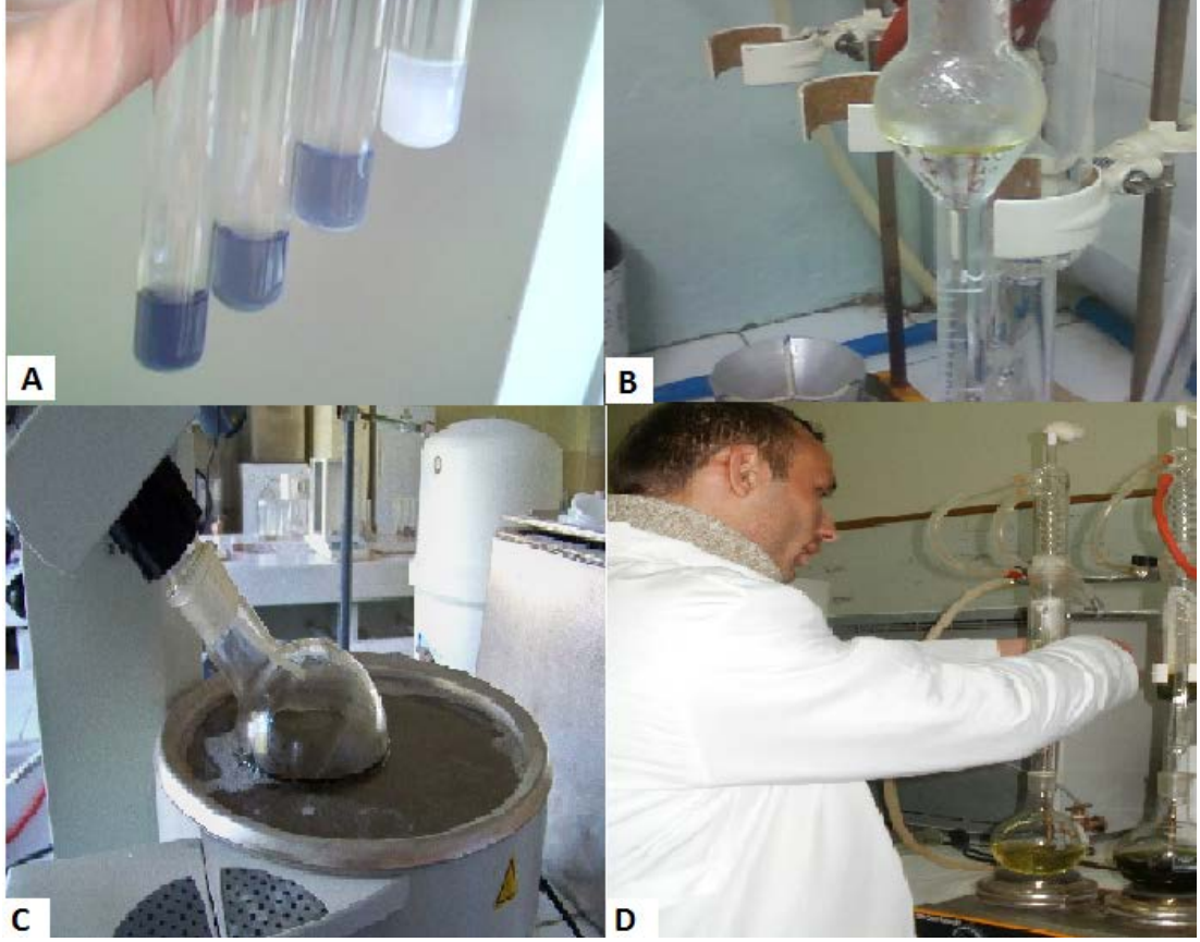
Şekil 3.1. A) Total fenoliklerin belirlenmesi; B) Clevenger ile uçucu yağların elde edilmesi; C) Pinus metanol özütlerinin evaporatör ile yoğunlaştırılması; D) Pinus yapraklarının Soxhlet cihazı ile özütlenmesi
