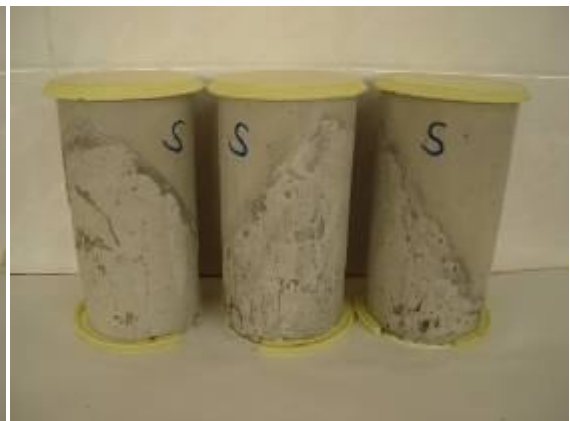
(d) S_ECC – substrate failure
