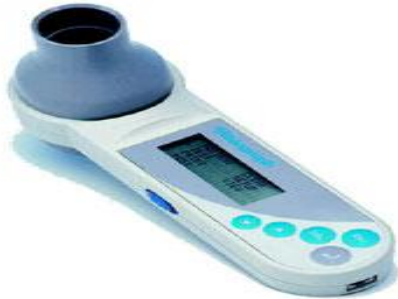
Şekil 9: Küçük el tipi spirometre
