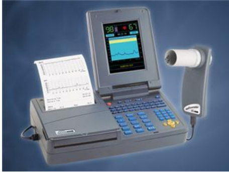
Şekil 8: Taşınabilir masaüstü spirometre
